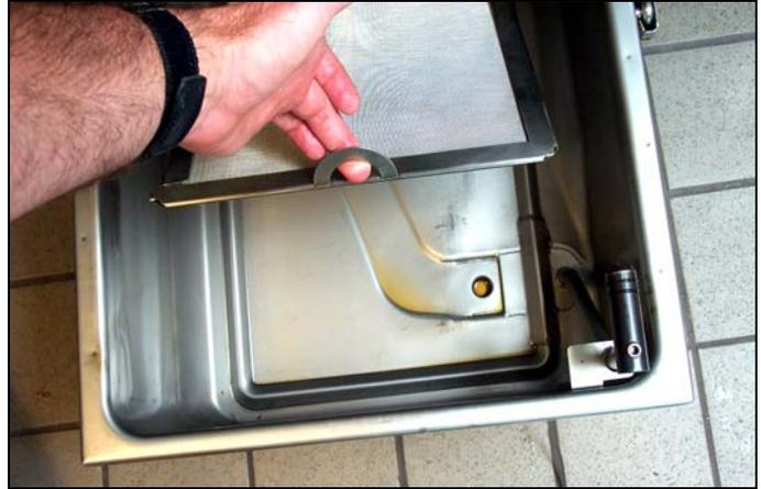
**Retire el ensamblaje de la malla de migajas y filtro de la fuente. Limpie todos los componentes con una solución de detergente y agua caliente, luego séquelos totalmente.**
