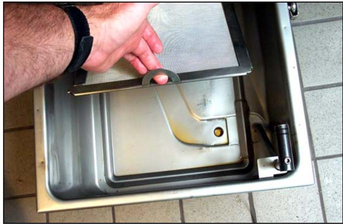
Vuelva a poner el ensamblaje del filtro en la fuente del filtro, revisando que el accesorio en el fondo del ensamblaje quede asentado firmemente en el orificio del fondo de la fuente. Espolvoree una taza de polvo de filtro Magnasol XL uniformemente sobre la malla.
