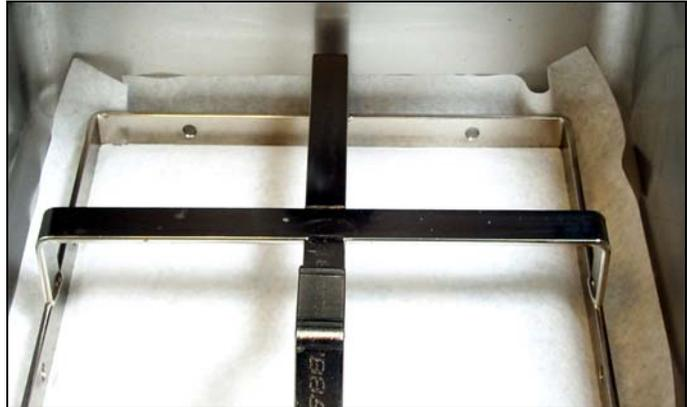
**Si usa papel de filtro, ponga el aro de sujeción encima del papel de filtro y baje el aro dentro de la fuente, permitiendo que se doble el papel hacia arriba alrededor del aro al empujarlo al fondo de la fuente. Cuando esté en posición el aro de sujeción, espolvoree uniformemente una taza de polvo de filtro sobre el papel.**
