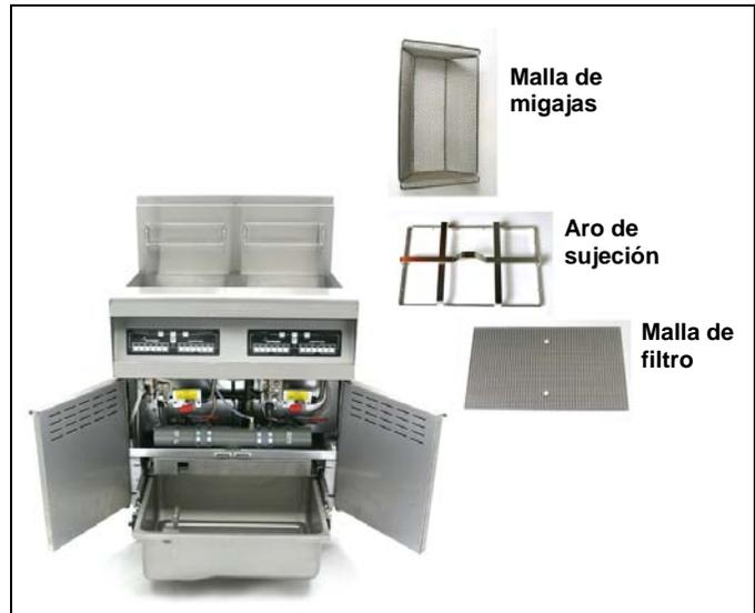
**Retire la malla de migajas, el aro de sujeción y la malla de filtro de la fuente. Limpie todos los componentes con una solución de detergente y agua caliente, luego séquelos totalmente.**
